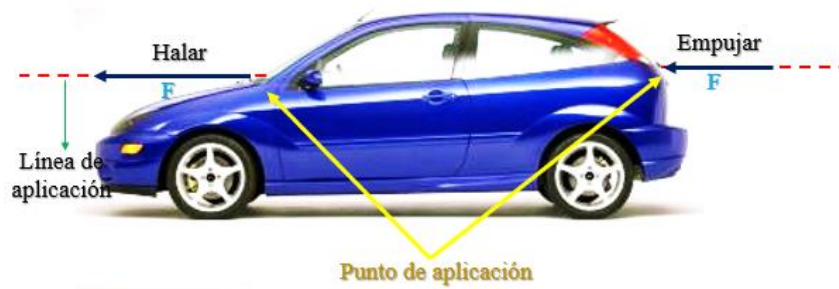
Figura 5: Principio de transmisibilidad
