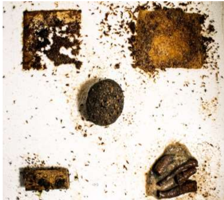
Figura 20. Cinco soportes en descomposición. Junio 27, 2019. Fuente: Autor del proyecto.
