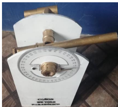
Figura 3 Cañon de tiro parabolico Elaborado por Anderson Jairo Mesa Juma
