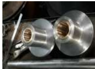
Figura 2.27. Construcción del bocín
