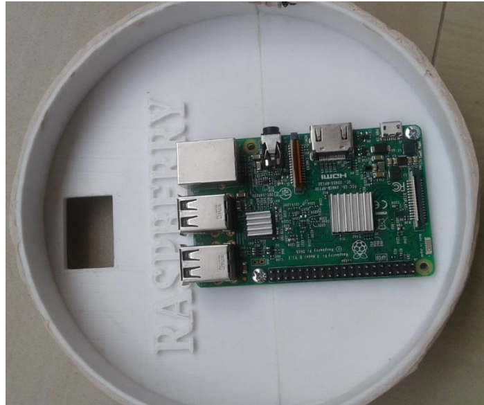
fig. 77. Montaje del Raspberry en el modelo Fuente: Propia
