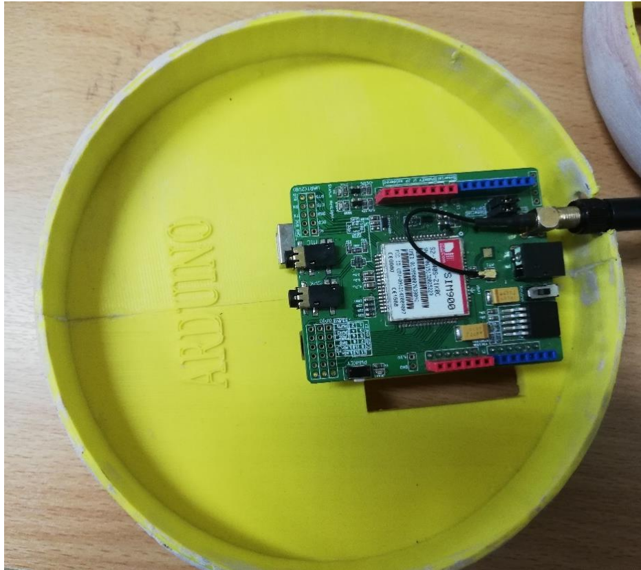
fig. 76: Acople de Arduino y módulo sim900 en diseño Fuente: Propia
