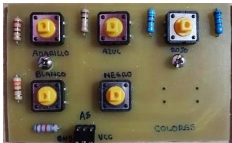
Circuito Armado Área de Colores
