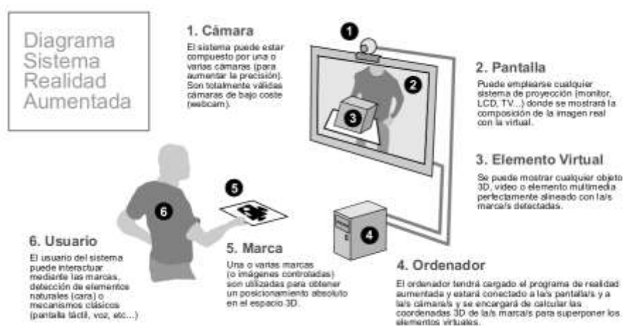
Ilustración 1. Diagrama Sistema de Realidad Aumentada
