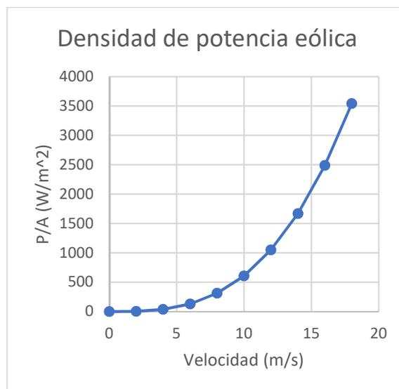
Figura 22. Densidad de potencia eólica disponible ( $W/m^2$ ) en función de la velocidad.
