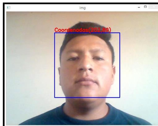
Fig. 20. Detección de rostros con *Haar Cascade* y sus coordenadas (x,y) dentro de la imagen
