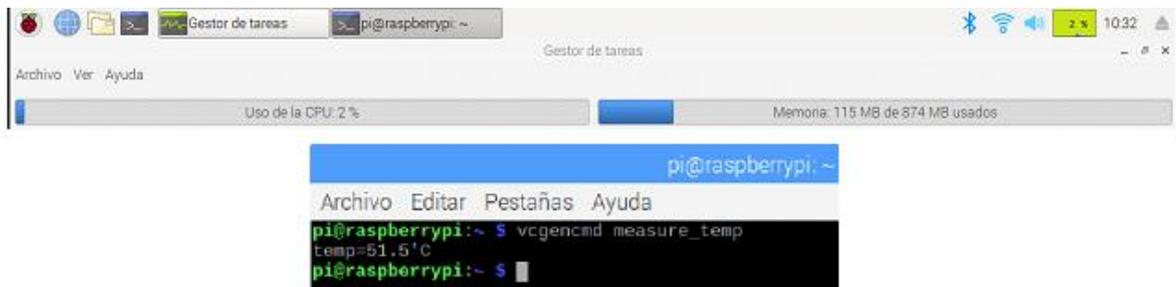
Fig. 41 Estado de CPU, RAM y temperatura sin ejecución del detector de somnolencia
