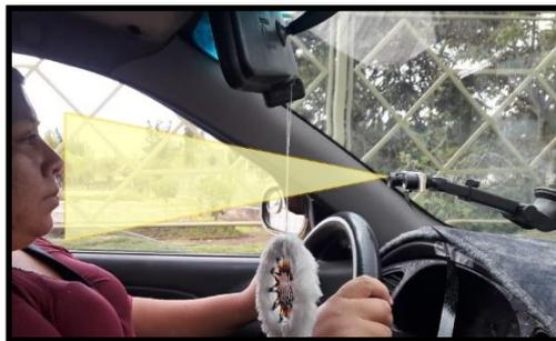
Fig. 45. Ubicación de la cámara dentro de la cabina del auto
