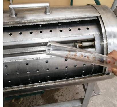
c. se muestra la plicación del ácido para el desiliconado de la tela.
