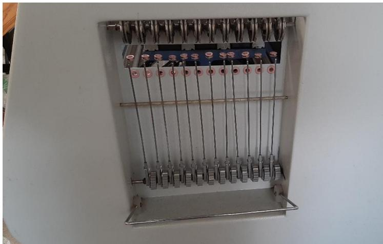
**Figura 50: Tensores laterales de una máquina rectilínea Wildhorse**
