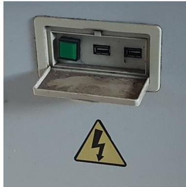
**Figura 42: Puertos USB de la máquina rectificadora Wild Horse**
