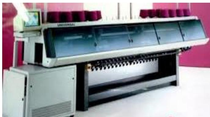
**Figura 55: Máquina rectilínea marca Universal**
