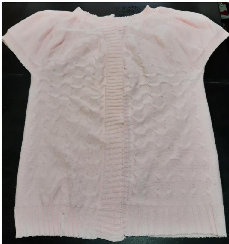
**ANEXO 8: Prenda integral estructurada completa obtenida en la máquina rectilínea Wild Horse E6-2 multigalga.**
