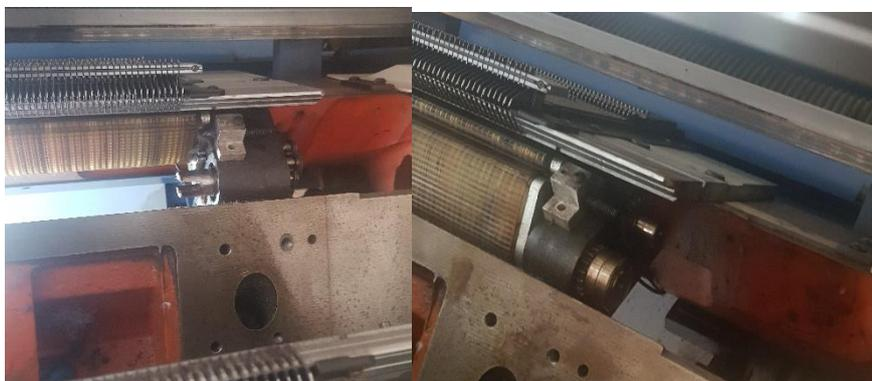
**Figura 51: Sistema de estiraje de la máquina rectilínea Wildhorse**
