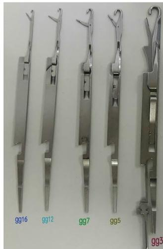
**Figura 46: Diferentes galgas de agujas de máquinas rectilíneas**
