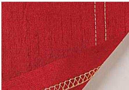
**Figura 33.** Puntada máquina recubridora
