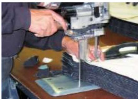
**Figura 26.** Máquina cortadora con cuchilla vertical
