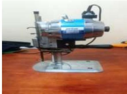
**Figura 25.** Máquina cortadora vertical
