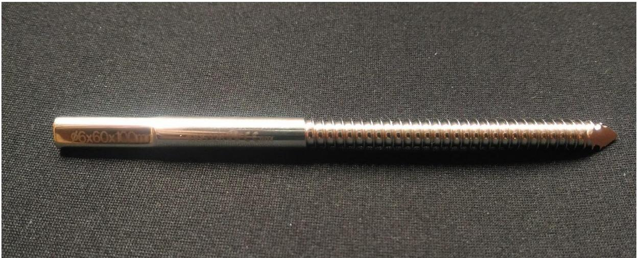
*Figura 13. Clavo Schanz autorroscante*
