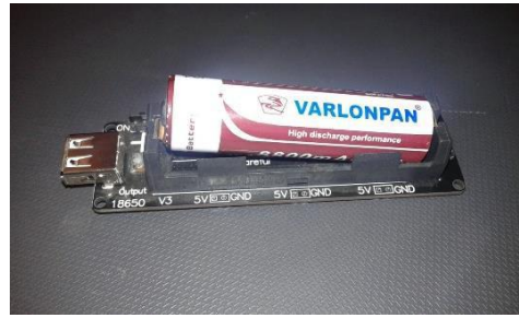
Figura 2-5 Batería Li-ion con su módulo de carga 18650 v3 utilizada para alimentación de placa raspberry, convertor y sensor.
