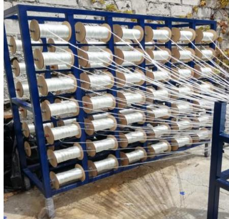
*Figura 29. Sistema de almacenamiento y desenrollado*
