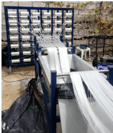
*Figura 31. Construcción del sistema de desenrollado y mojado*
