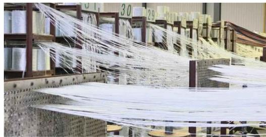
Figura 11. Sistema de almacenamiento y guía de los refuerzos (Hilo roving). [38]
