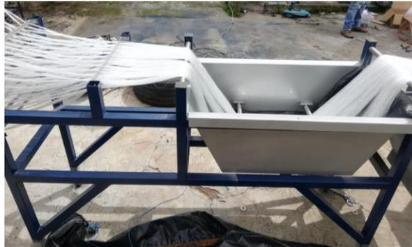
*Figura 30. Sistema de impregnación de resina*
