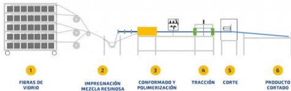
Figura 10. Etapas del proceso de pultrusión. [34]
