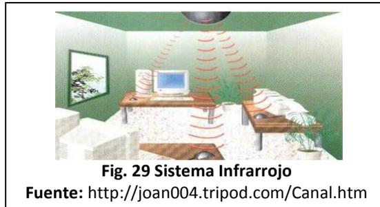
Los emisores y receptores de infrarrojos deben estar alineados o bien estar en línea tras la posible reflexión de rayo en superficies como las paredes. En infrarrojos no existen problemas de seguridad ni de interferencias ya que estos rayos no pueden atravesar los objetos (por ejemplo paredes). Tampoco es necesario permiso para su utilización. [19]
