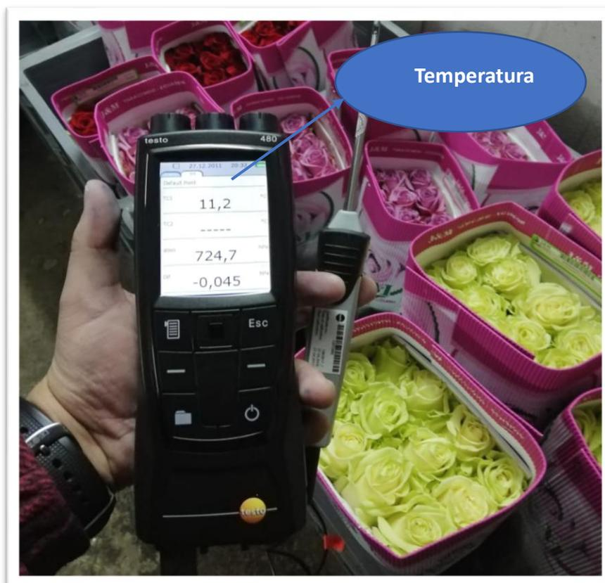
Figura 16. Medición de riesgos físicos temperatura Testo 480
