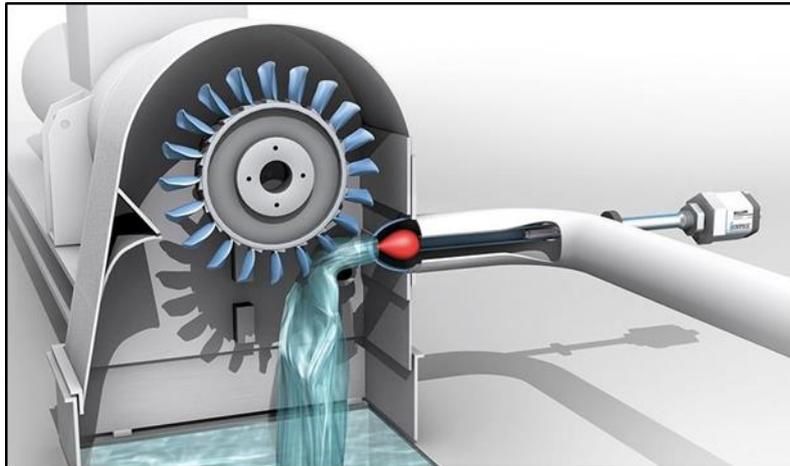
Fig. 19. Turbina Pelton de un inyector.
