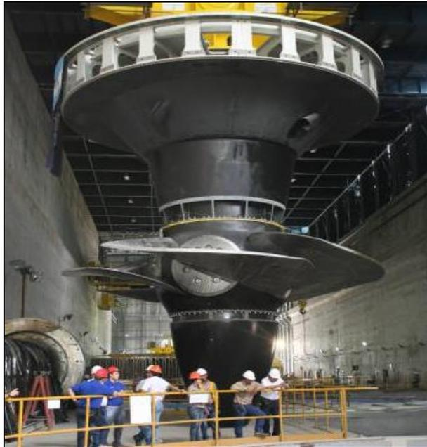
Fig. 23. Turbina Kaplan.
