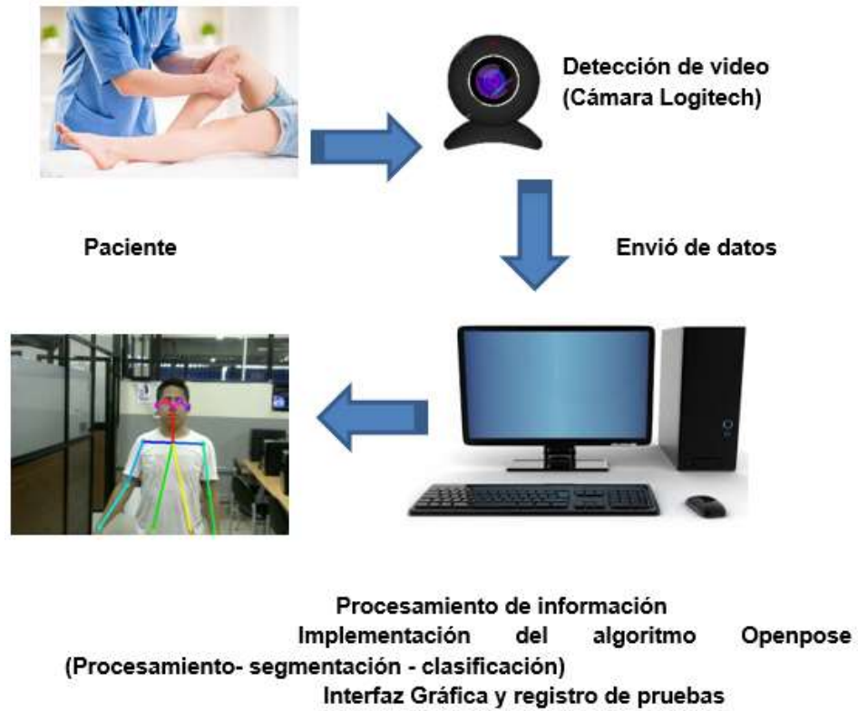
Figura 20. Arquitectura del funcionamiento del sistema
