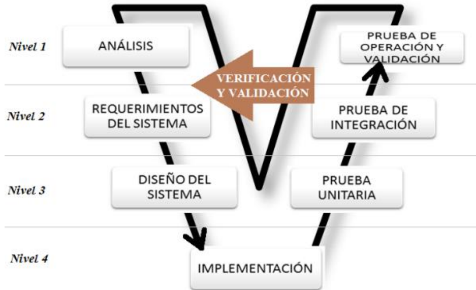
Figura 19. Modelo en V para el desarrollo de proyectos Fuente. Adaptado de (Perez, Berreteaga, Ruiz de Olano, Urkidi, & Perez, 2006)
