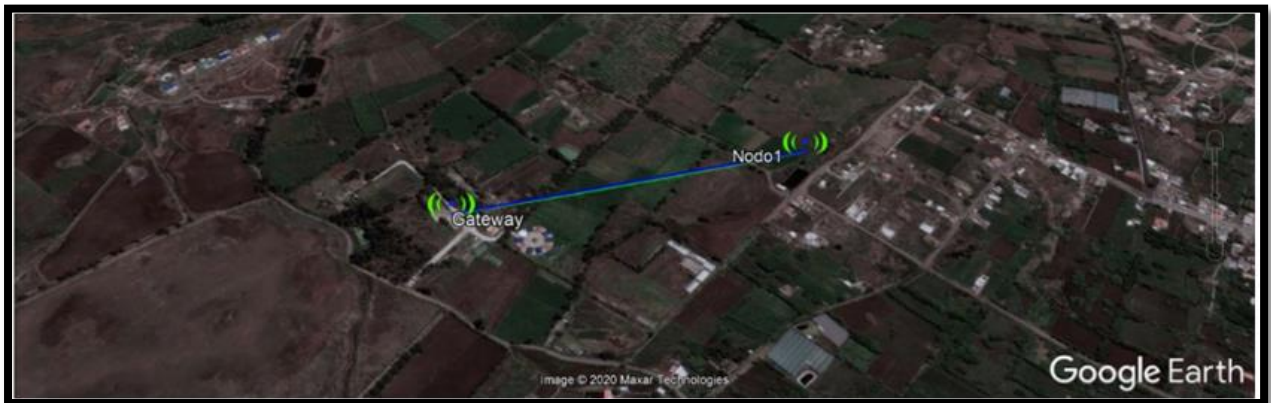
Figura 39. Línea de vista entre el nodo central y nodo sensor. Fuente: Obtenido de Google Earth.
