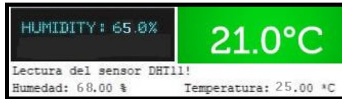
Figura 94. Verificación de la humedad relativa y temperatura del compost orgánico con la aplicación móvil.
