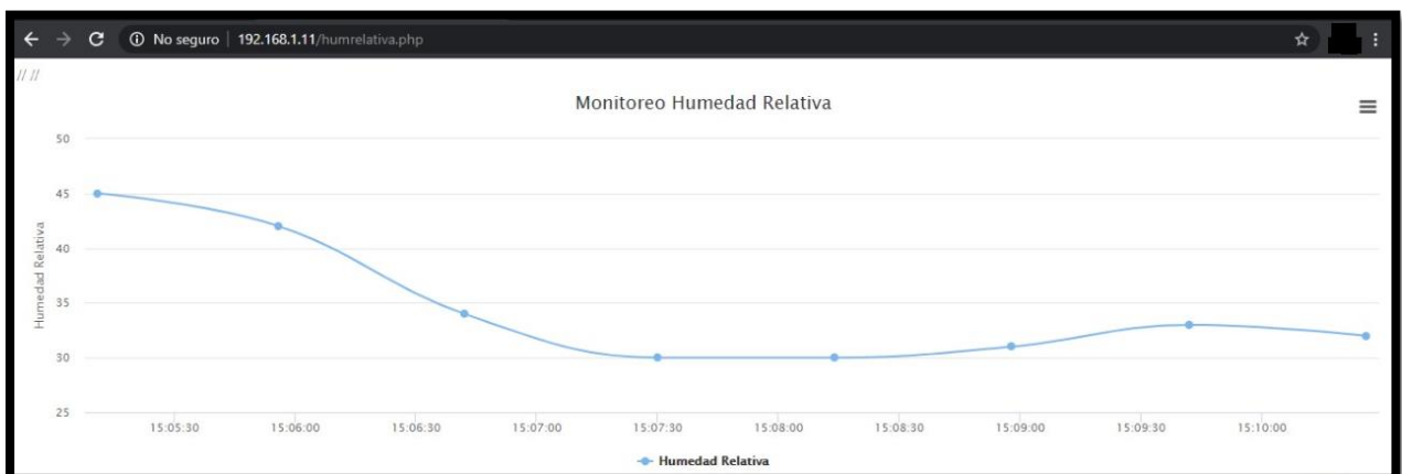
Figura 90. Datos de la variable Humedad Relativa
