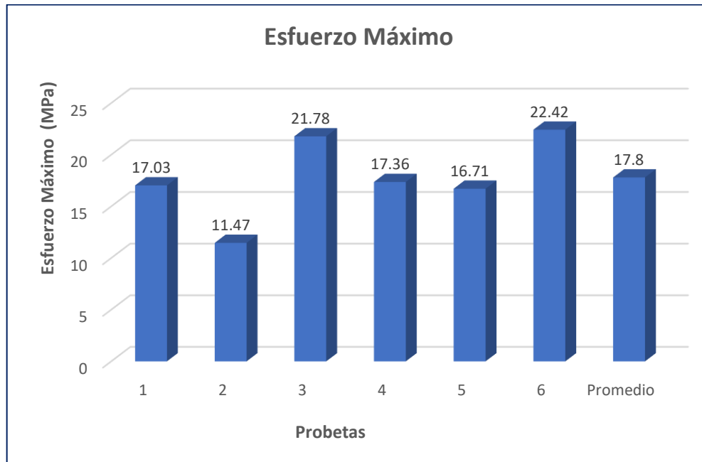
Figura 3.13 Esfuerzo máximo probetas a flexión segundo material- primera configuración
