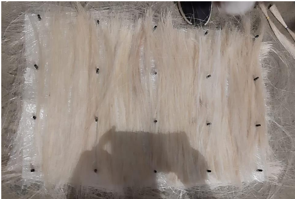
Figura 2.8 Colocación de la fibra en los moldes para mezclar con resina
