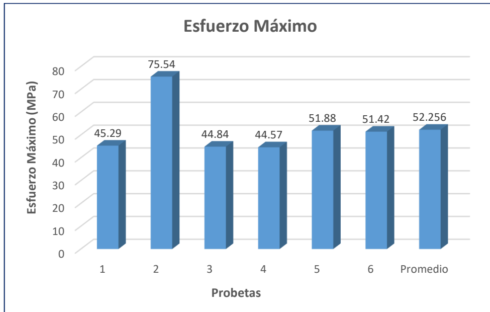
Figura 3.1 Esfuerzo máximo probetas a tracción primer material- primera configuración
