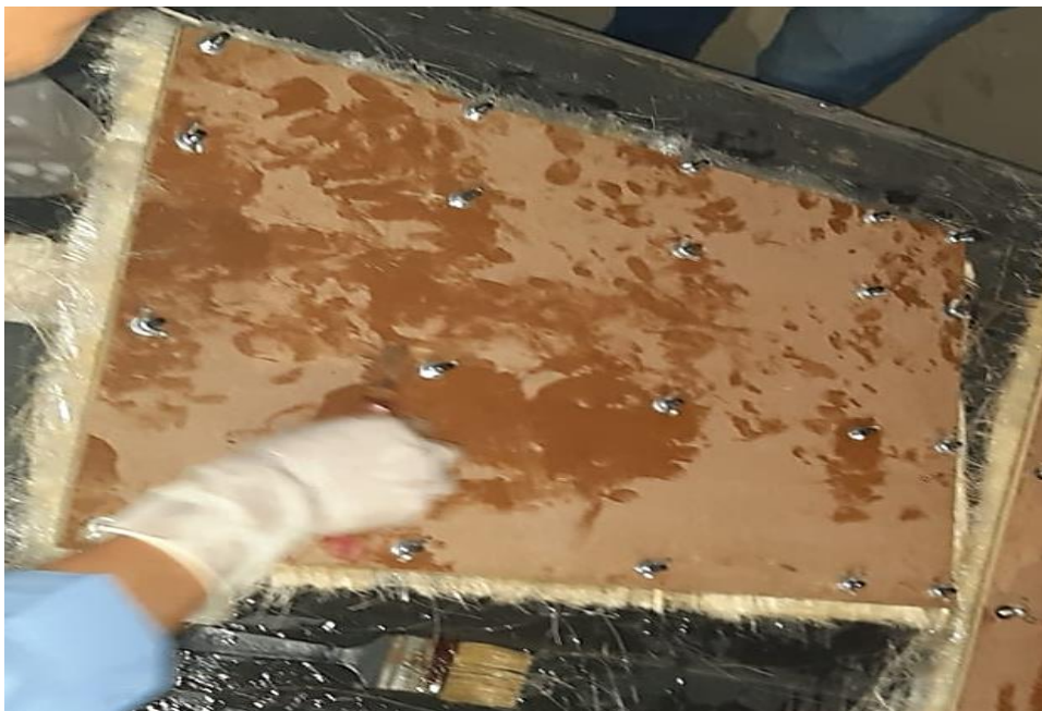
Figura 2.10 Colocación de la tapa del molde
