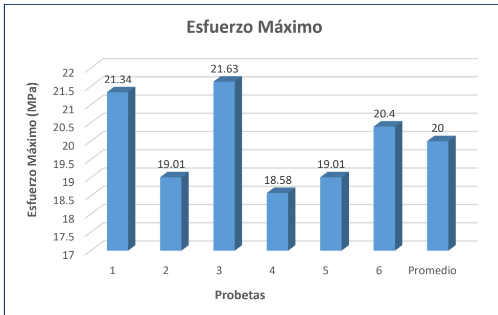
Figura 3.9 Esfuerzo máximo probetas a flexión primer material- primera configuración
