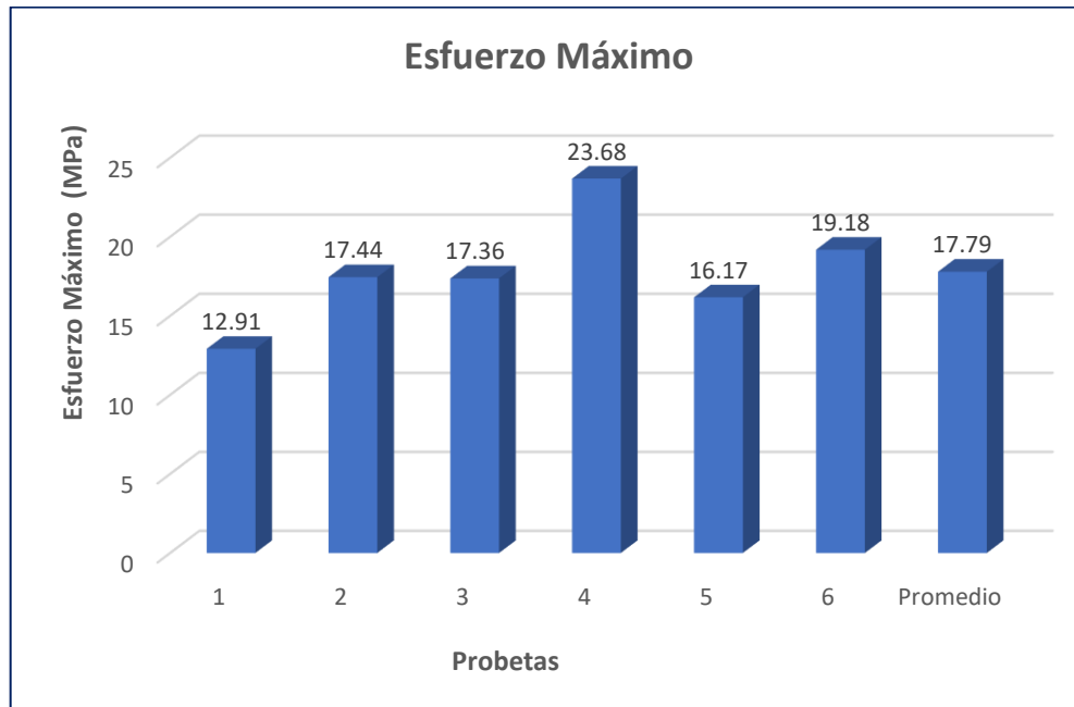
Figura 3.15 Esfuerzo máximo probetas a flexión segundo material- segunda configuración
