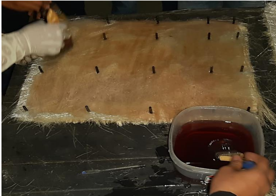
Figura 2.9 Molde completo con fibra y resina
