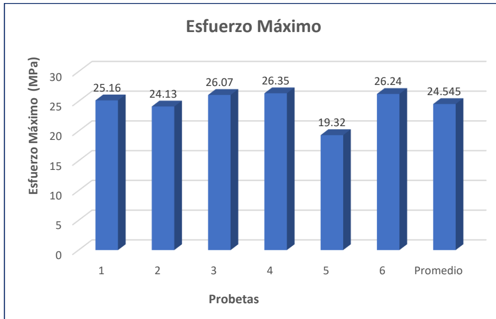
Figura 3.7 Esfuerzo máximo probetas a tracción segundo material- segunda configuración
