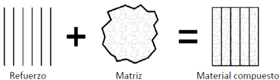
Figura 1.4 Componentes de un material compuesto (Imbaquingo, 2018)
