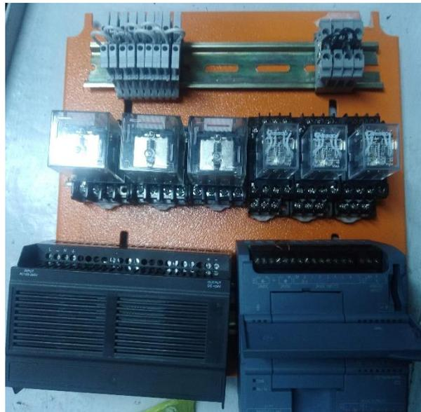
*Figura 2-21 Ubicación de los componentes del automatismo en el doble fondo*
