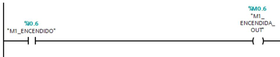
Figura 2-4 Programación estado máquina
