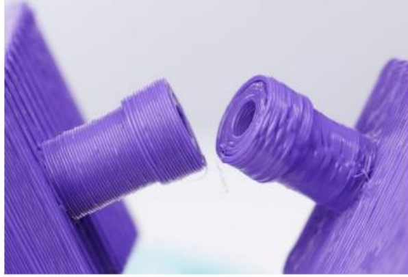
Figura 51. Error en la adherencia de las capas debido a una velocidad de impresión muy elevada [13].
