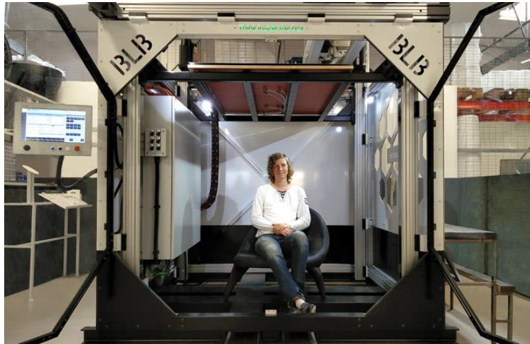
Figura 13. Impresora Box BLB Industries con volumen de impresión de 1500 x 1100 x 1500mm [27].
