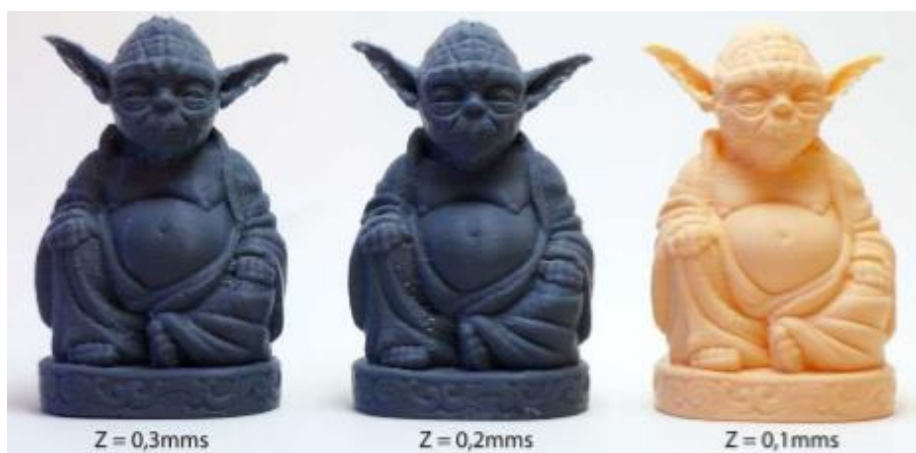
Figura 45. Prototipos con diferente espesor de capa [42].
