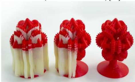
Figura 35. Fases del PVA utilizado como material de soporte [48].
