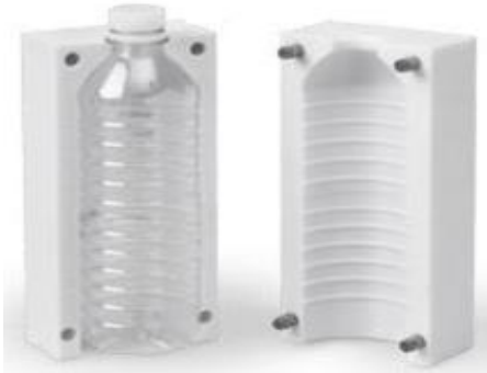
Figura 38. Molde para fabricación de botellas impreso en Policarbonato [33].
