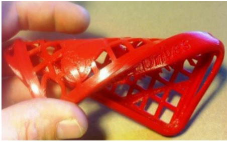
Figura 34. Estuche de móvil donde se aprecia la flexibilidad del TPE [33].
