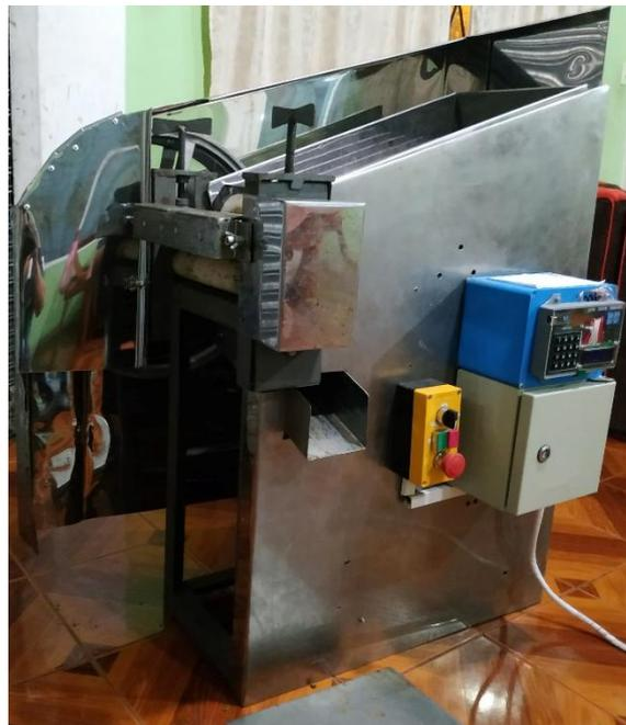
*Ilustración 27: Máquina desgranadora*
