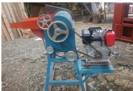
*Ilustración 3: Máquina desgranadora de fréjol seco*
