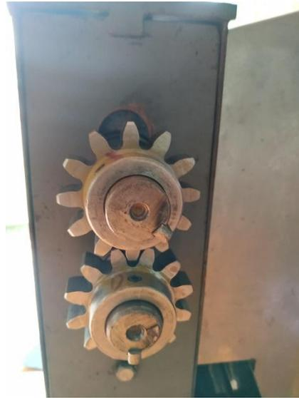
*Ilustración 26: Mecanismo de engranajes*
