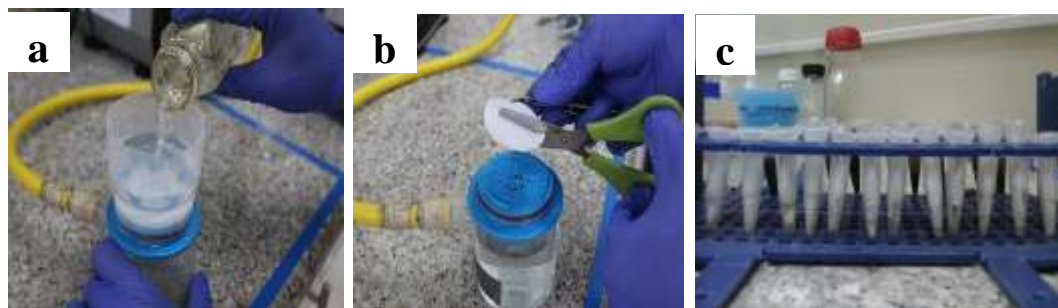
Figura 6. Proceso de extracción de eDNA de muestras de agua a) Filtración de muestra, b) corte de membrana y c) extracción de ADN
