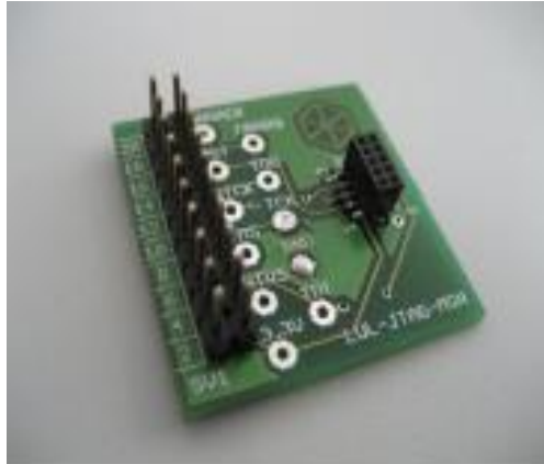
Figura 3.16: Placa convertidor JTAG hembra de 20 pines a 10 pines
