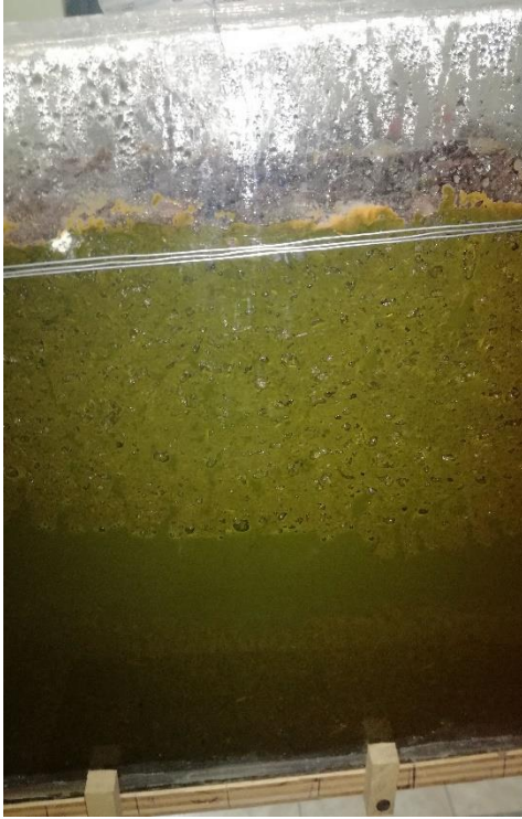
Fotografía 9 y 10. Sedimentos en el reactor uno (parte inicial y parte final del reactor)
