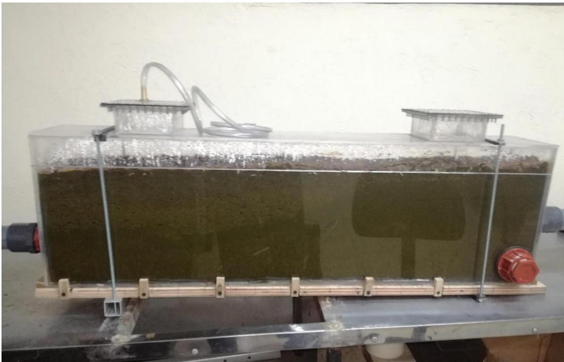
Fotografía 8. Distribución de sedimentos en el reactor uno (formación de canales)
