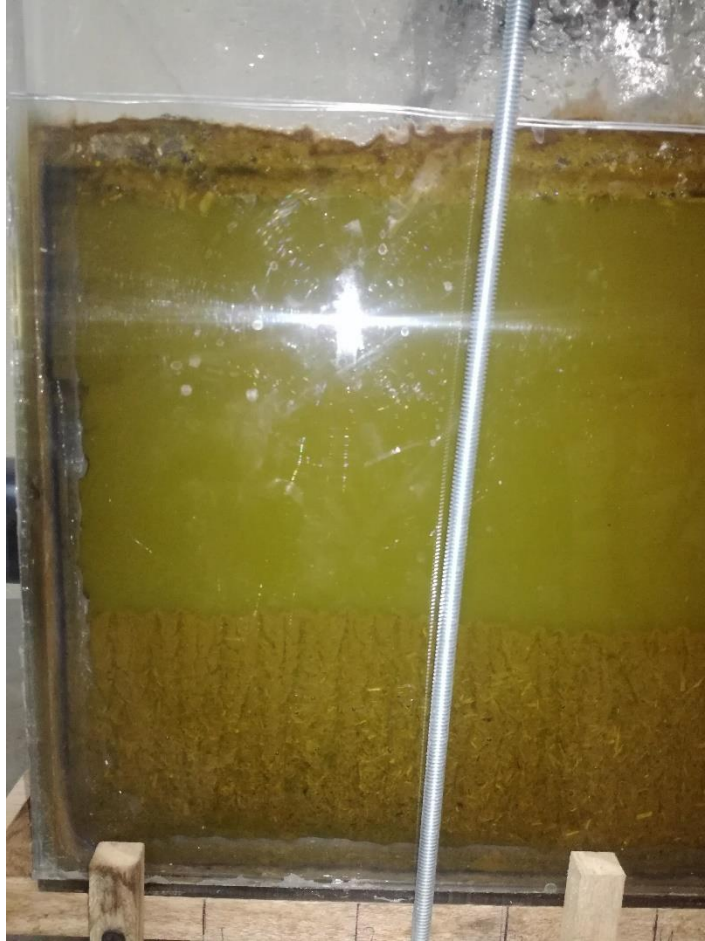
Fotografía 12. Sedimentos en el reactor dos
