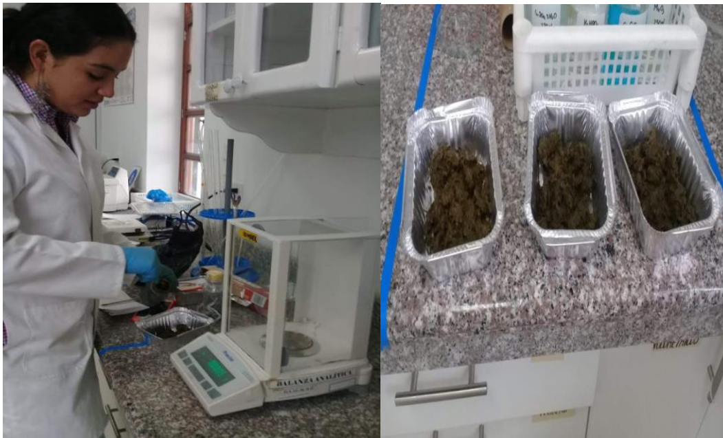
Fotografía 4 y 5. Medición de humedad en las muestras de materia orgánica
