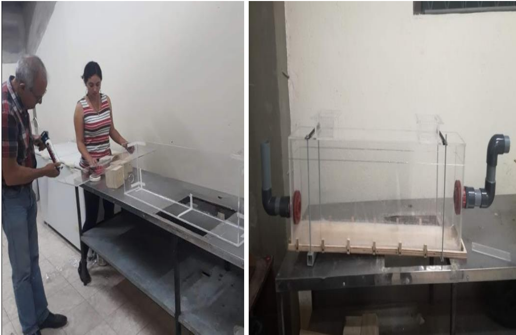
Fotografía 1 y 2. Ensamblaje de los reactores
