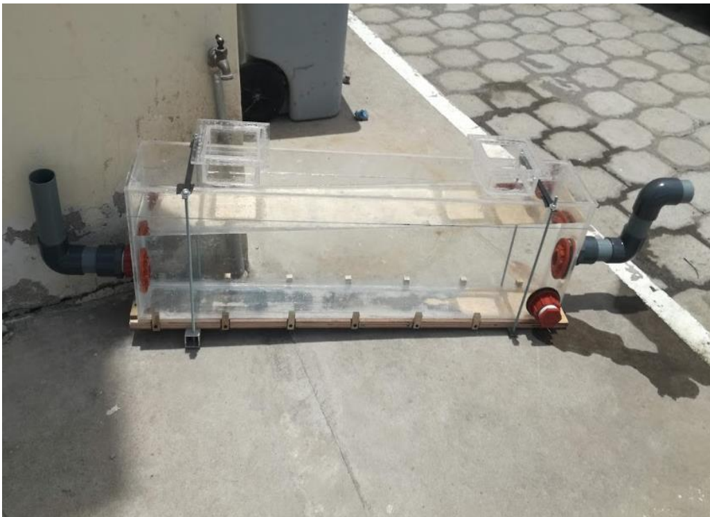
Fotografía 3. Pruebas de agua para la verificación de fugas
