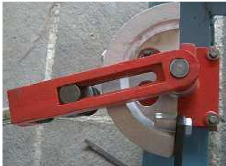
Figura 1.1 Dobladora de tubo redondo manual.
