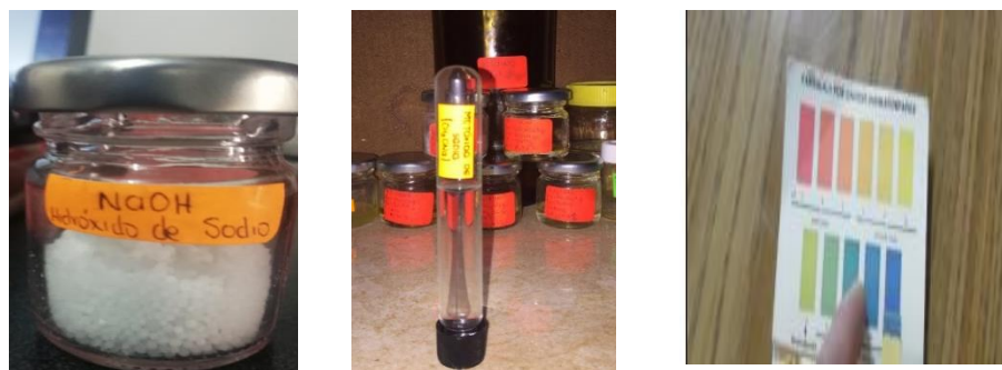
Figura 14. Determinación de pH del Metóxido de Sodio
