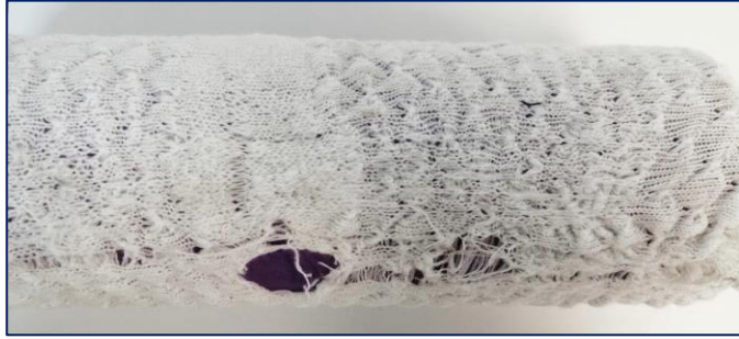
Falla por daño eléctrico
