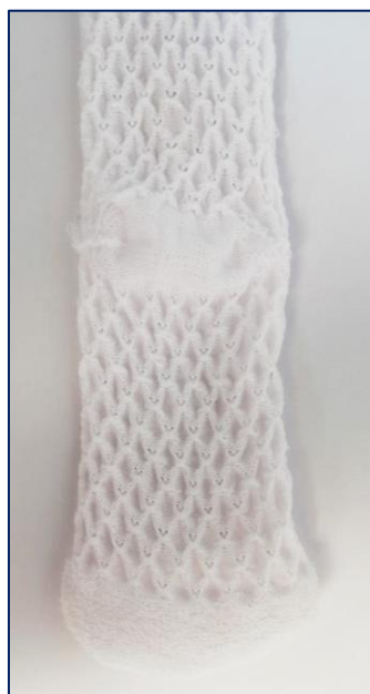
Falta de hebra en talón
