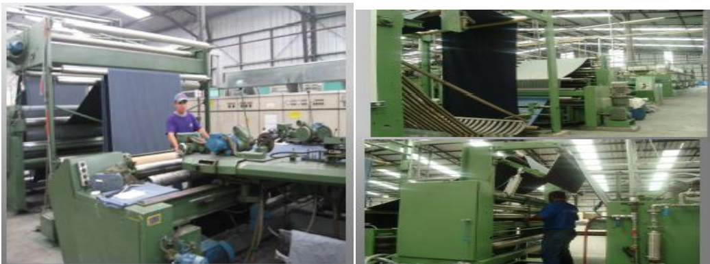
Fig. 4.5 Rama Termo fijadora
