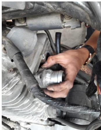
Figura 2. 7 Extracción de colectores de admisión para limpieza y mantenimiento
