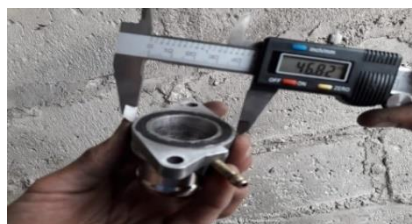
Figura 2.2 Toma de medidas con calibrador pie de rey
