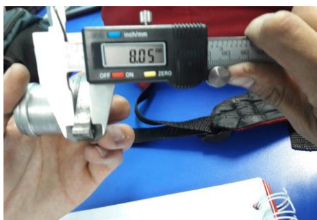
Figura 2. 8 Toma de medidas e identificación de colectores de admisión
