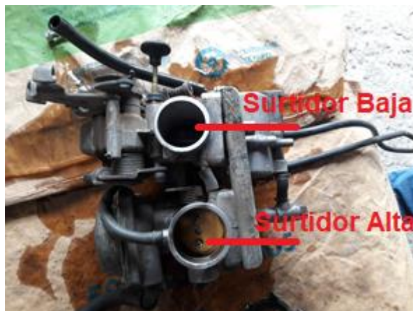
Figura 2. 10 Surtidores de alta y baja de carburador
