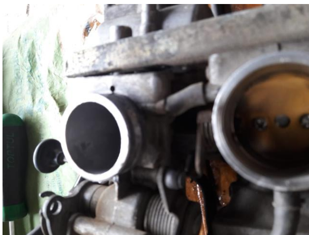
Figura 2. 9 Carburador Teikei, serie Y26PV/1 doble Venturi
