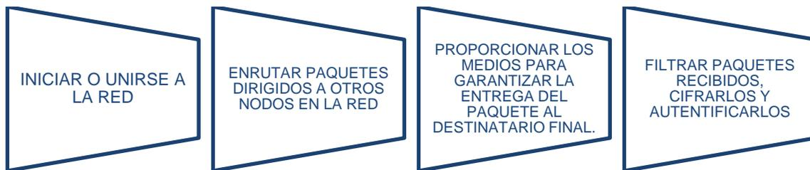
**Figura 5. Procedimientos de la capa de red. [7]**
