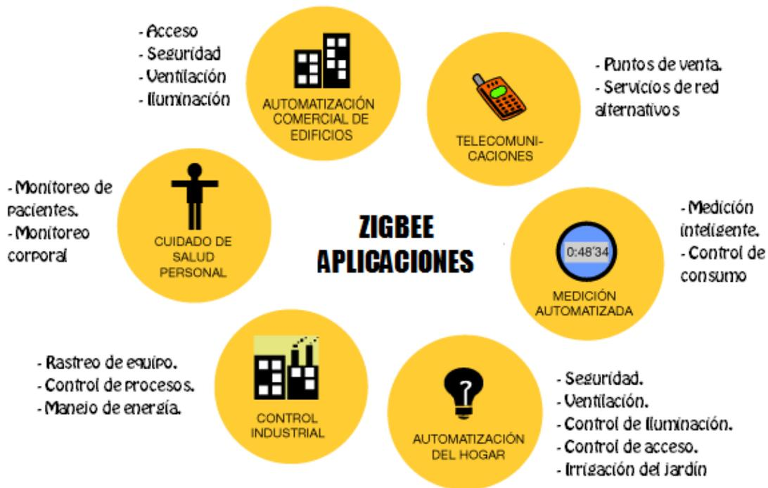
Figura 18. Aplicaciones de ZigBee [7]
