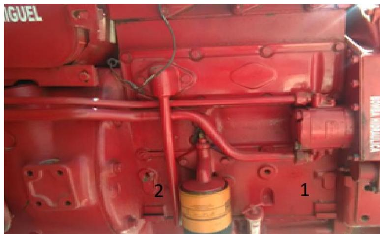
**Figura 40** Parte inferior del motor "cárter"
