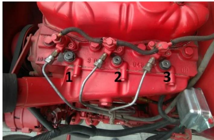
**Figura 43** Puntos de medición en los inyectores
