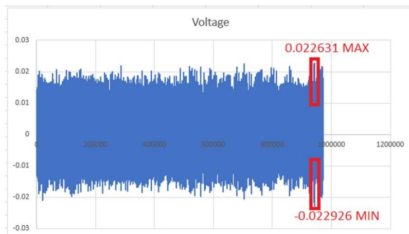
**Figura 48** Señal del inyector 2 en 2500 RPM
