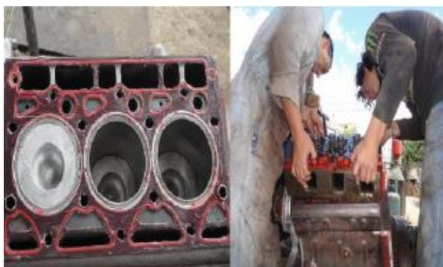
**Figura 16** Daños en los cilindros
