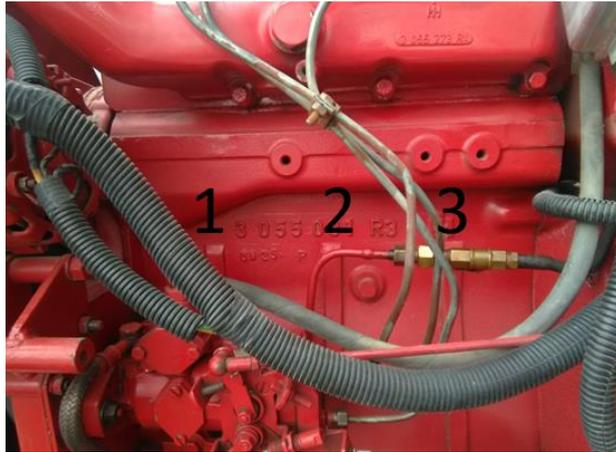
**Figura 50** Punto de medición en el "bloque"
