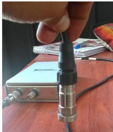
**Figura 25** Sensor de vibración
