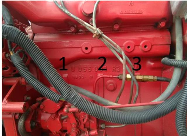
**Figura 69** Punto de medición en el bloque por falla en los cilindros
