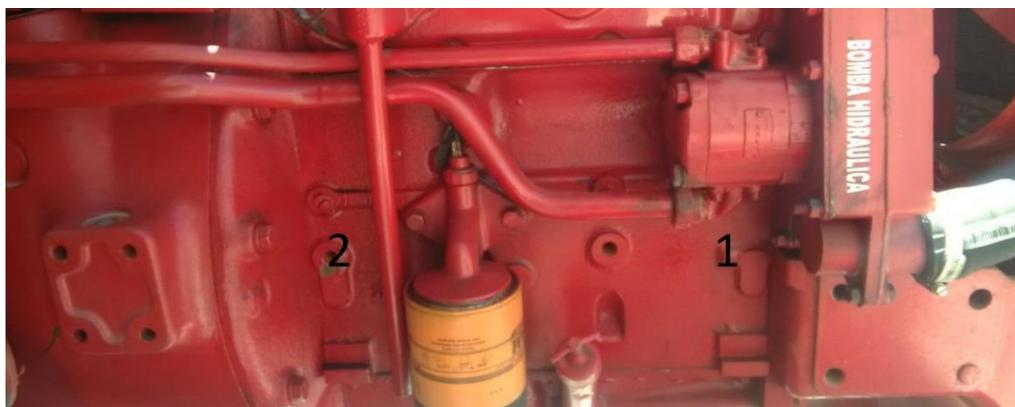
**Figura 57** Punto de medición en el cigüeñal
