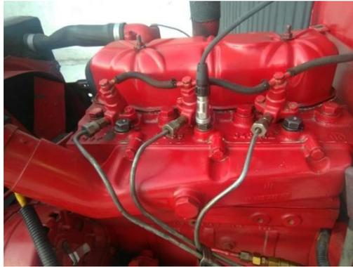
**Figura 62** Punto de medición de fuga de combustible en los inyectores
