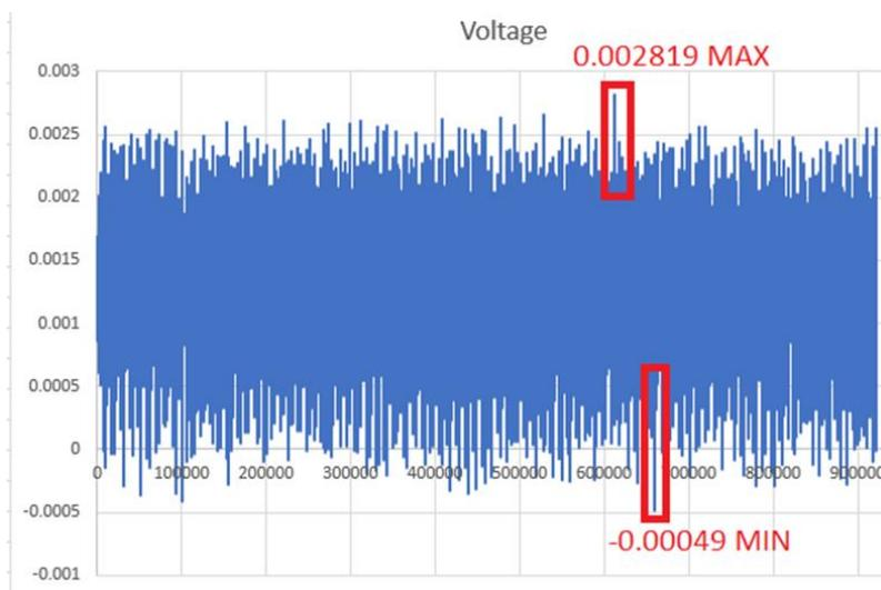
**Figura 46** Señal del inyector 3 en ralentí
