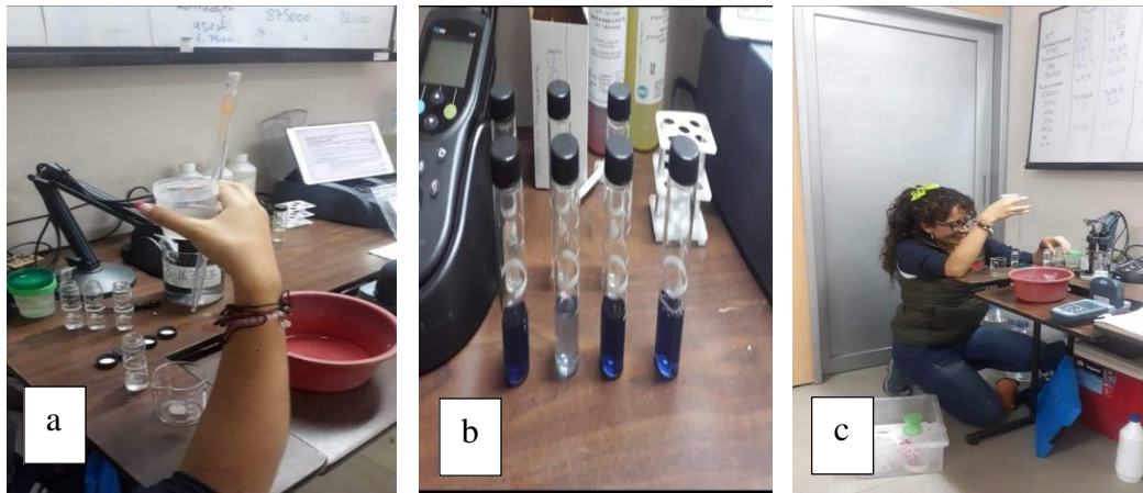
Figura 9. a.) Análisis de nitritos y nitratos, b.) Análisis de fosfatos, c.) Análisis de parámetros físicos, medición de turbiedad y conductividad
