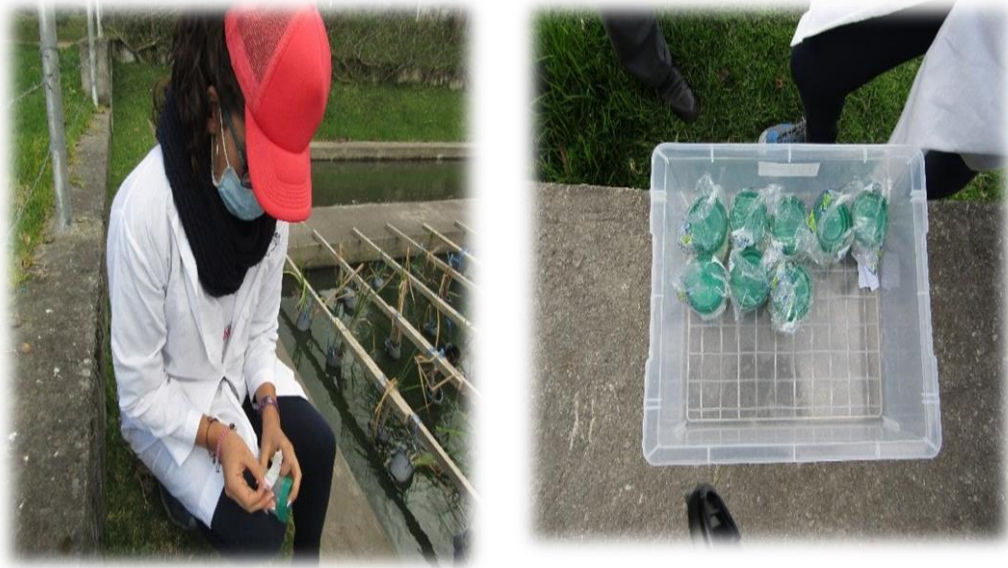
Figura 37. Etiquetado de muestras, transporte y colocación de muestras en el kit de transporte.
