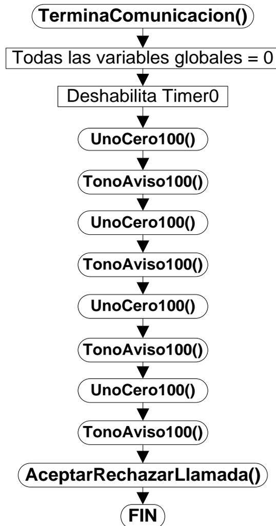
**Figura 2-31** Diagrama de flujo del subprograma “*TerminaComunicacion*”
