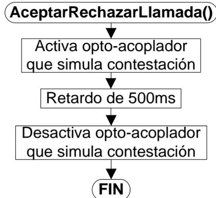
**Figura 2-32** Diagrama de flujo del Subprograma “AceptarRechazarLlamada”
