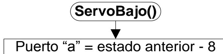
**Figura 2-40** Diagrama de flujo del Subprograma “*ServoBajo*”
