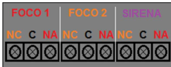
**Figura 3-6** Conexión de los dispositivos eléctricos en la caja metálica
