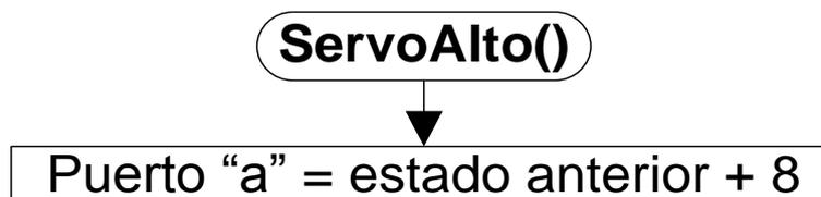
Figura 2-39 Diagrama de flujo del Subprograma “*ServoAlto*”
