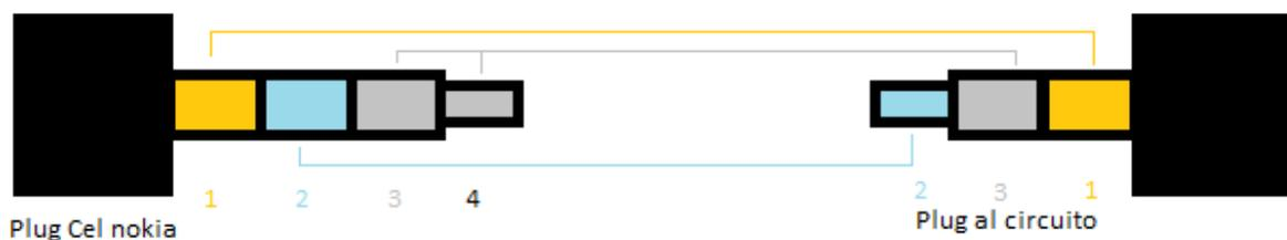
**Figura 2-11** Conexión de hilos del cable para envío y recepción de tonos
