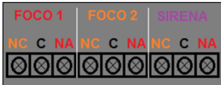
Figura 15. Conexión de los dispositivos eléctricos en la caja metálica
