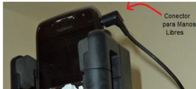
Figura 3.- Conector para la conexión Dispositivo servidor - Módulo principal
