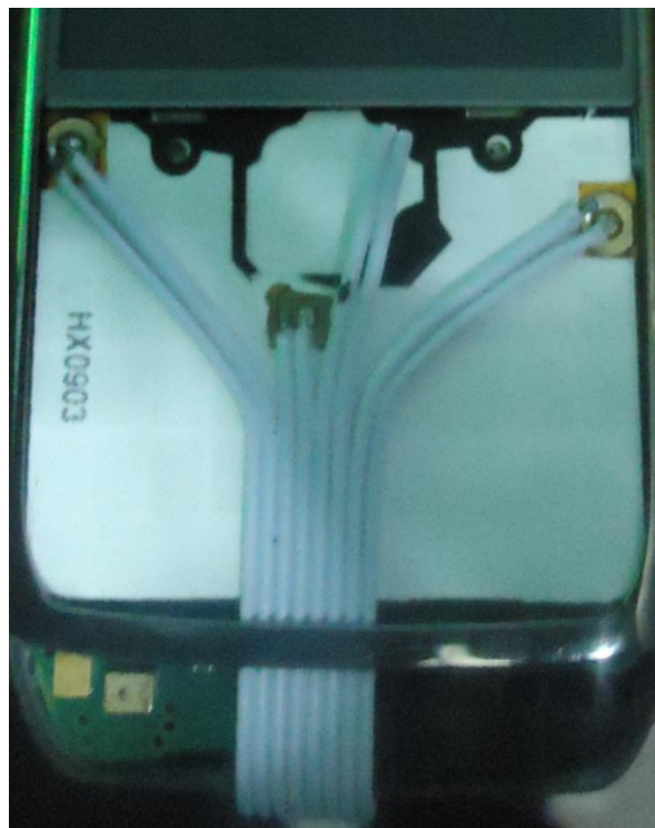
Imagen 10.- Soldas en el teclado del dispositivo servidor (Fuente: propia)
