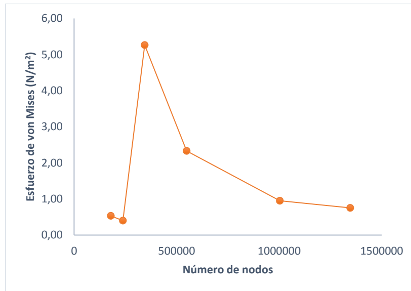
Fig. 3.2. Análisis de convergencia para el esfuerzo de von Mises y el número de nodos de cada modelo desarrollado.
