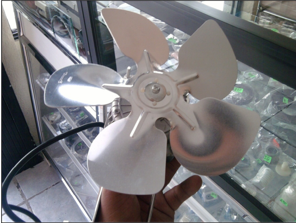
Gráfico N°22: Ventilador de Extracción
