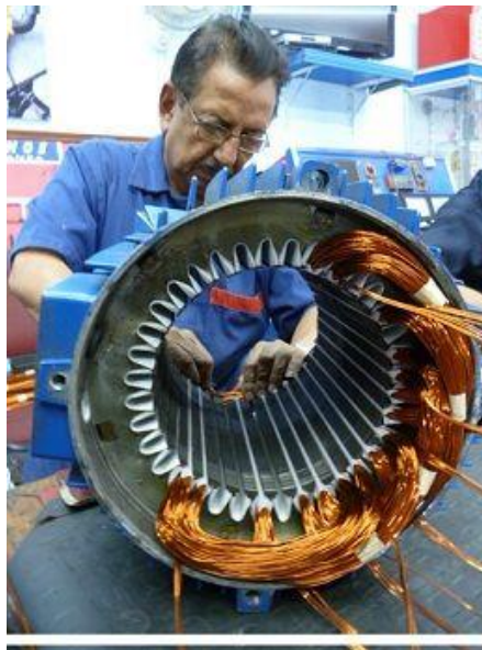
Ilustración 4: Rebobinado de un motor que se ha sido retirado de la línea de producción.
