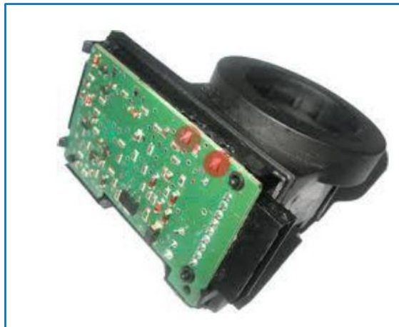
Figura 1.7 Antena conectada al Módulo del Inmovilizador (Chinga, 2013, pág. 52)
