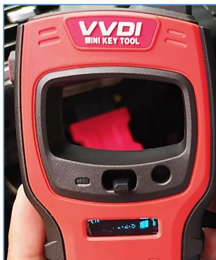
Figura 3.61 Colocación chip virgen en equipo VVDI
