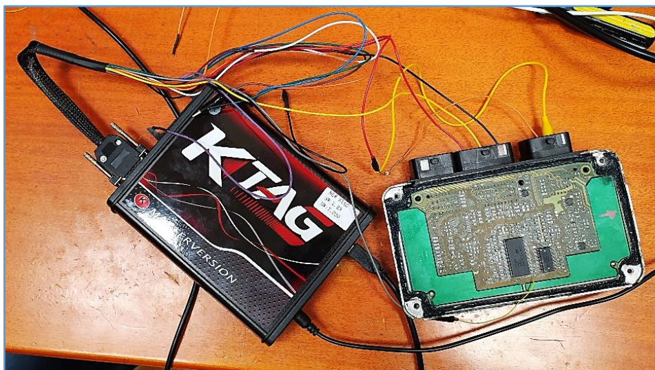
Figura 3.27 Conexión K-TAG con la centralita
