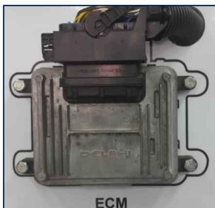
Figura 1.4 Modulo de control electrónico ECU (Cevallos C. M., 2016, pág. 35)
