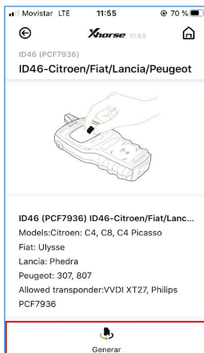
Figura 3.62 Generar transponder (Captura obtenida del equipo MINI-VVDI)
