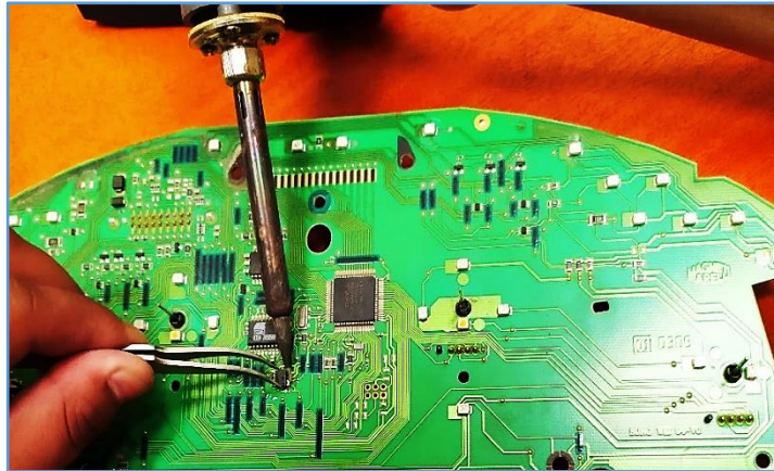
Figura 3.44 Extracción de memoria EEPROM del panel de instrumentos
