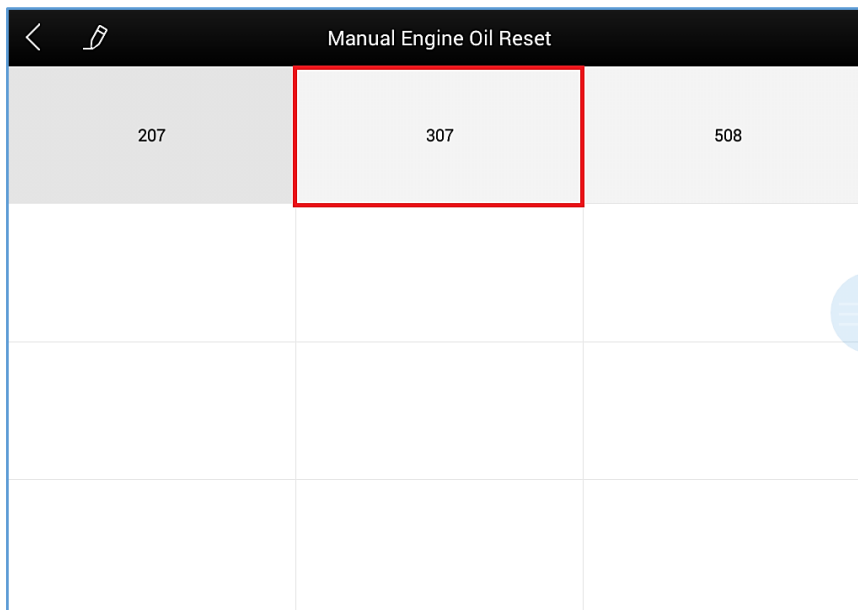
Figura 3.12 Menú selección modelo del vehículo - Reset luz de servicio (Captura obtenida del equipo X100 PAD 2 PRO)
