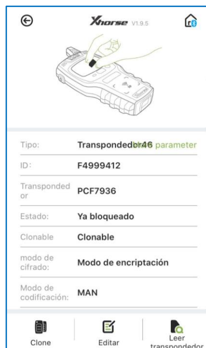
Figura 3.57 Código de transponder (Captura obtenida del equipo MINI-VVDI)
