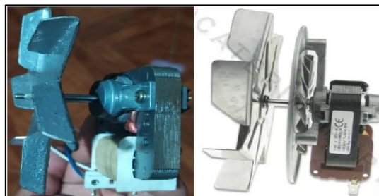
Fig. 0.5. Ventilador para horno de convección: a) Elaborado, b) Comercial.
