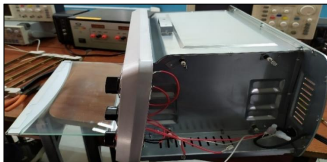
Fig. 0.2. Extracción de elementos y modificación del Horno.
