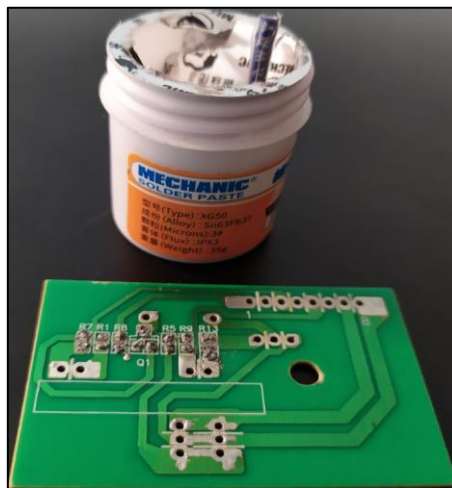
Fig. 0.27. Colocación de soldadura en pasta (Sn63Pb37) en pads.
