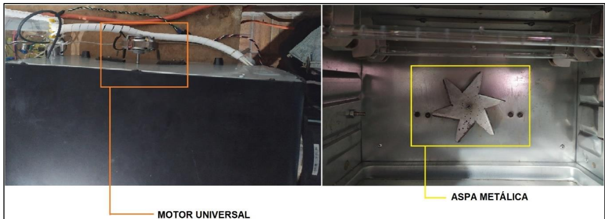
Fig. 0.4. Instalación de ventilador de convección.
