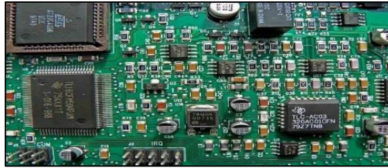
Fig. 0.5. Encapsulado SMD con y sin terminales.
