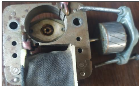
Fig. 0.36. Revisión de partes móviles del motor universal.
