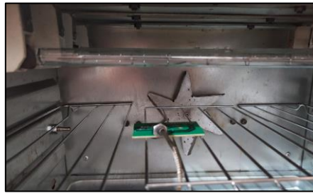
Fig. 0.29. Colocación de PCB en equipo de soldadura.
