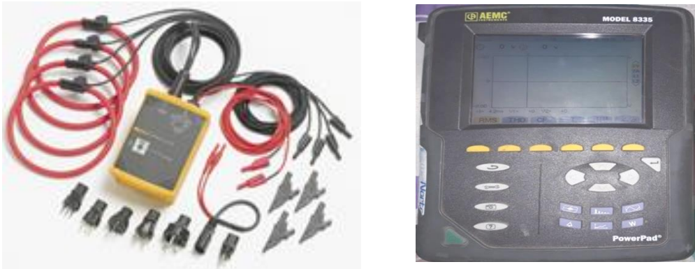
Fig. 2.2. Analizador de red FLUKE 1744 y el AEMC 8335
