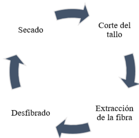
Figura 3. Proceso de extracción de la fibra de abacá
