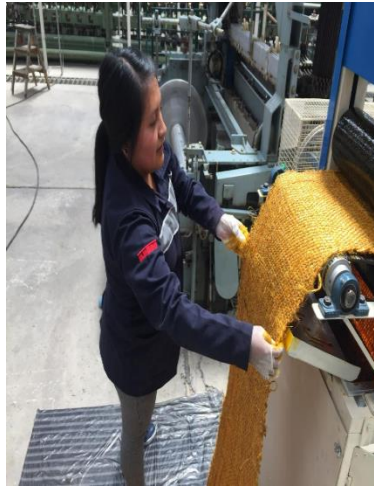
Figura 23. Paso del tejido por el Foulard
