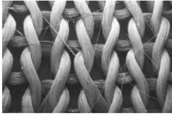
Figura 10: Vista ampliada del género de punto (Jersey)
