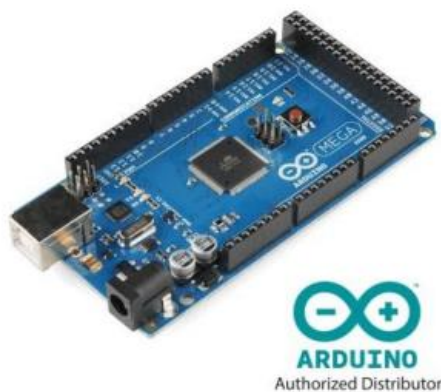
Figura 2.5 Características de la placa Arduino mega 2560
