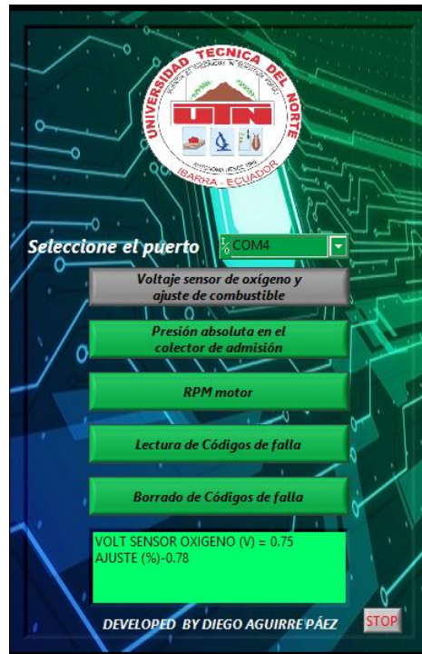
Figura 3.23 Prueba de Voltaje del sensor de oxígeno y ajuste de combustible
