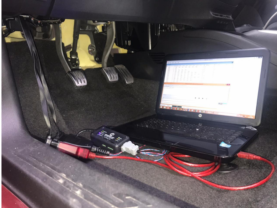
Figura 3.5 Conexión del ELM 327 y el CAN BUS Analyzer
