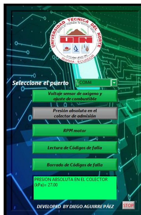
Figura 3.24 Prueba de presión absoluta en el colector de admisión
