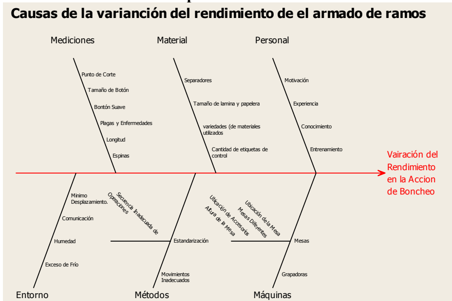
Gráfica 6.10. Diagrama Causa –Efecto: Variación del rendimiento en la actividad de boncheo, Elaborado por Nataly Molina.
