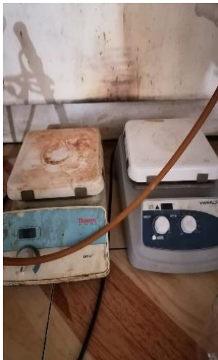
Anexo 11. Planchas de digestión
